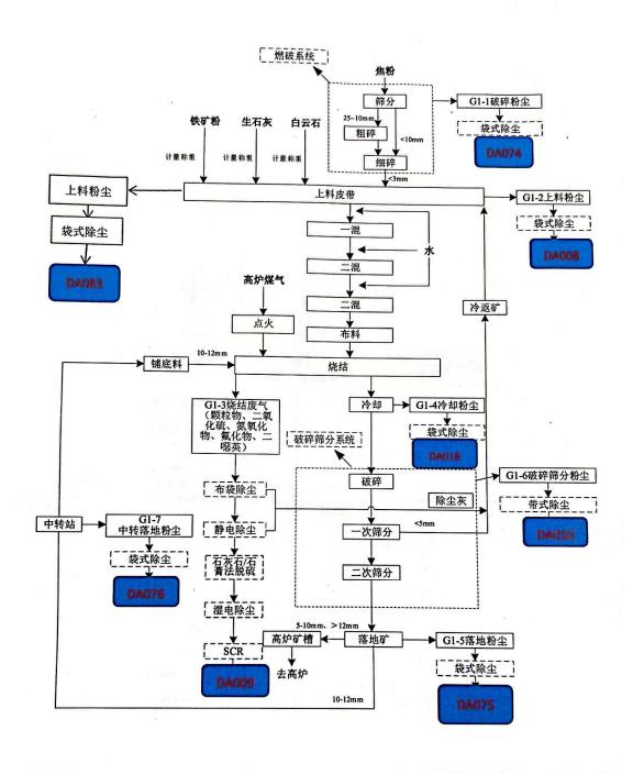
图 3.5-1 烧结车间生产工艺流程及产污环节示意图
