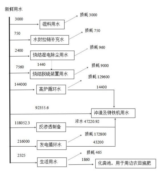
图 3.4-1 一期第一时段项目水平衡图 (单位: m³/a)
