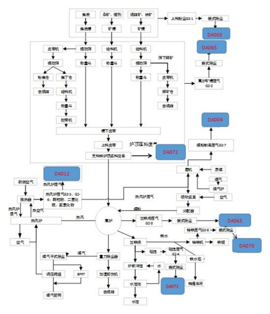
图 3.5-2 高炉车间生产工艺流程及产污环节示意图
